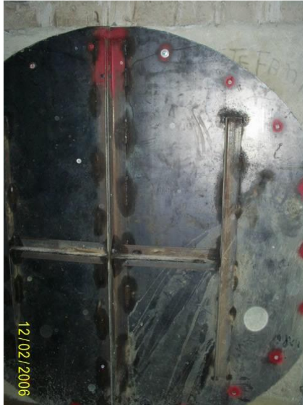
Ensamble de tapón para prueba hidrostática en túnel, transvase de aguas al lago fortuna.
